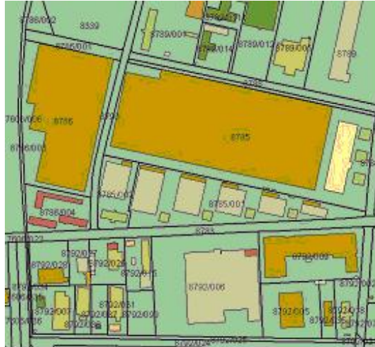
Abbildung 4: Bisheriges Verfahren: Die Gebäude wurden mit den Flurstücken resp. Flurstücknummern verknüpft.
