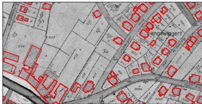
Abbildung 3: Halbautomatische Methode zur Validierung einer alten Karte (1941) mit Hilfe der ALK-Daten.
